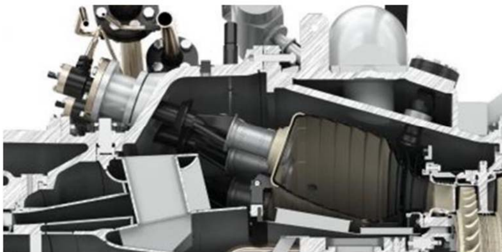
Hình 1.3 Cấu tạo buồng đốt kiểu DLE thế hệ thứ 3 [72]
