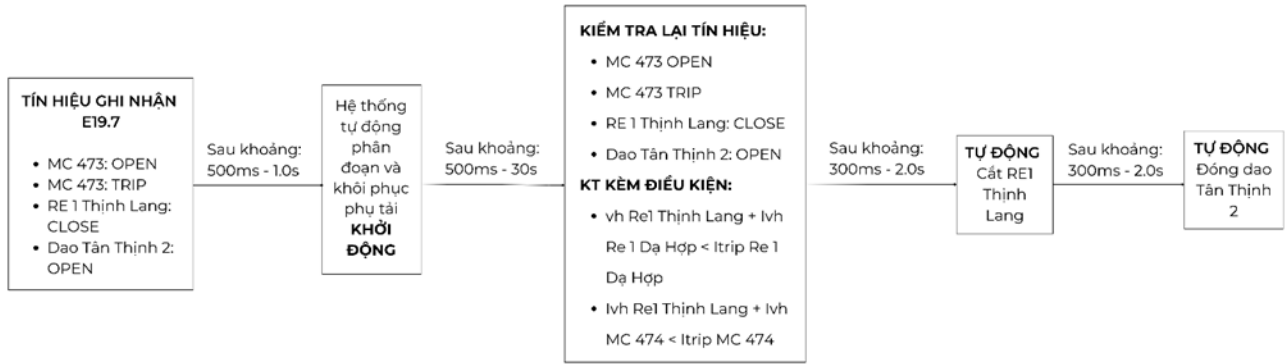
Hình 3. 11: Sơ đồ trình tự vận hành hệ thống Tự động phân đoạn và khôi phục phụ tải khi sự cố MC 473 E19.7 nhảy, tự đóng lại xấu
