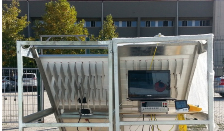
a) BTN bằng nhôm có cánh gián đoạn [84]
