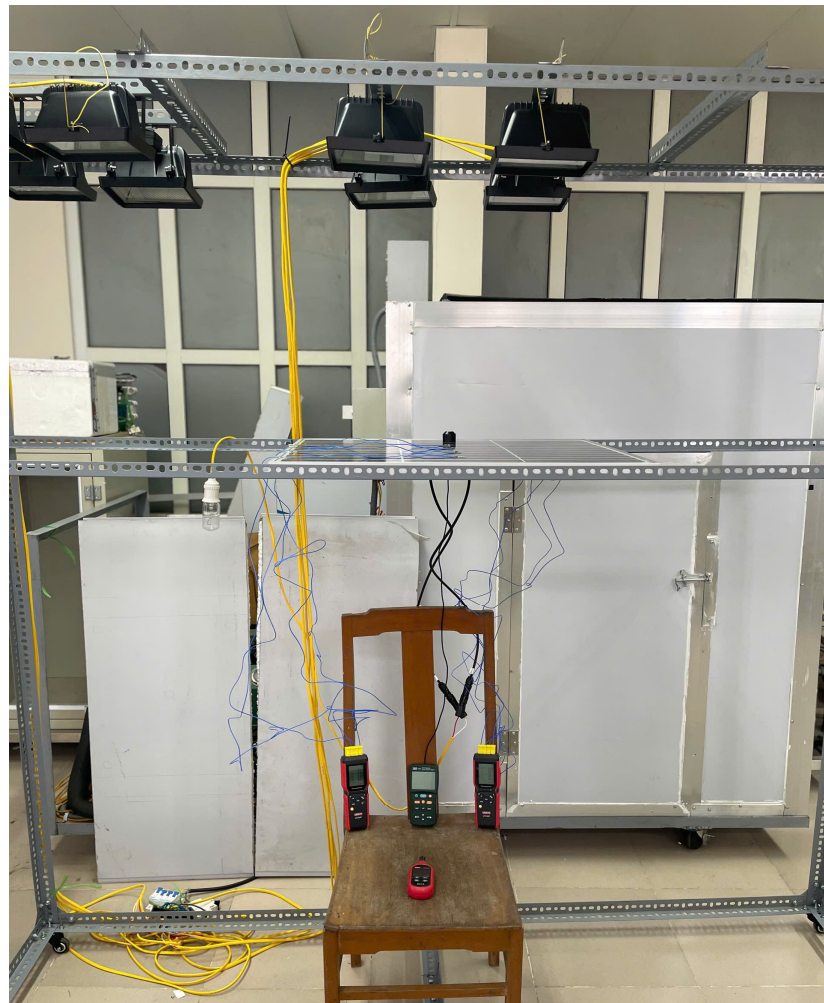
Hình 3.10. Hình ảnh đánh giá sơ bộ khả năng làm mát tấm PV của các BTN
