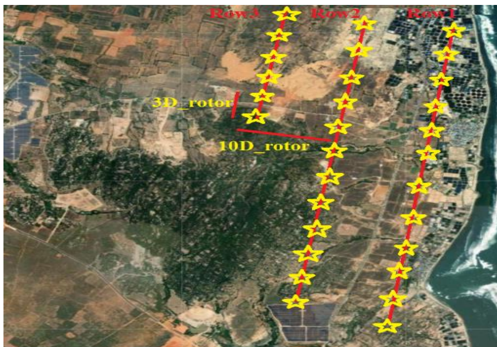
Hình 4.20. Cấu hình lắp đặt các tuabin E103 tối ưu tại trang trại
