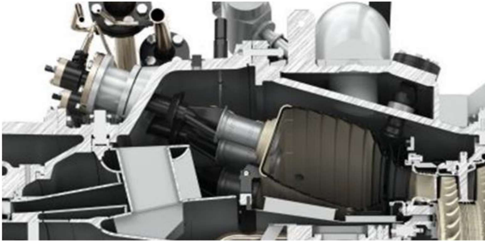
Hình 1.3 Cấu tạo buồng đốt kiểu DLE thế hệ thứ 3 [71]
