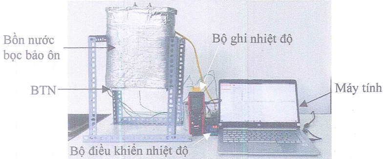
Hình 3.5. Mô hình thực nghiệm đánh giá hiệu quả truyền nhiệt của BTN
